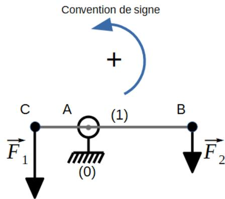
Le  $M_A(\vec{F}_1)$  sera compté positivement car il a tendance à faire tourner le mécanisme dans le sens de la convention de signe.
